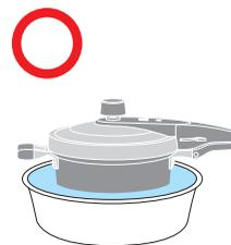
蒸らし時間を10分以上おいてふたを開けるときは、オモリを傾け、蒸気を完全に抜いてからオモリを取ります。また、火を消した直後(通電を切った直後)にふたを開けるときは、オモリをつけたまま1分間冷やした後、オモリを取ります。感圧ピンが下がったら、安全確認レバーを押しながら、静かにふたを取っ手を右方向へ少しまわし、一旦止めてふたの隙間から蒸気が出ないことを確認してからふたを開けてください。
